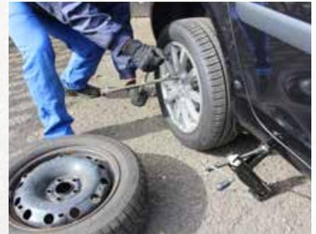
• Die abmontierten Reifen auf der Lauffläche kennzeichnen, zum Beispiel mit Wachskreide („VR“ für „vorne rechts“, „HL“ für „hinten links“ etc.). So vermeiden Sie beim nächsten Wechsel Unklarheiten. | Direkt nach der Reifenmontage sollte unbedingt der Luftdruck geprüft werden. Außerdem rät der ADAC spätestens nach 50 Kilometern die Schrauben zu prüfen.
