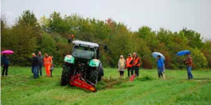
Neues Doppelmesserbalken-Mähwerk wird vorgestellt | Beim Mähen mit dem üblichen Kreiselmäherwerk werden leider oft Insekten und auch andere Tiere verletzt oder getötet, weil das geschnittene Gras mit hoher Geschwindigkeit im geschlossenen Mähwerk verwirbelt wird. Viel besser ist da die Mahd mit einem Messerbalken-Mähwerk: Das gemähte Gras fällt nur um. Insekten können entweder während der Mahd hochfliegen oder danach aus dem Schwad herauskrabbeln.
